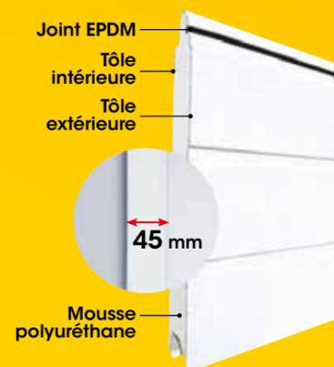
Les panneaux de la gamme Iso 45, de part leur composition, sont les plus isolants du marché. Ils bénéficient d'un excellent coefficient thermique ( $0,44 \text{ W/m}^2\text{K}$ ).
