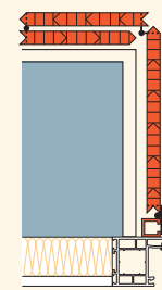
Disposition N°5 : ferrage sur tapées alu- minium anodisé four- nies - comprise barre de battue haute - 1 VL en tableau, les autres en façade
